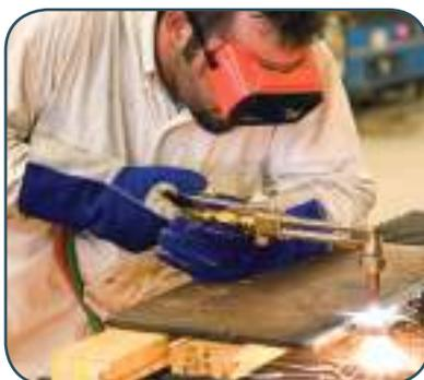
Figura 13 - Maçarico oxiacetilénico usado para soldar e cortar. O oxigénio utilizado provém de uma das botijas e o acetileno da outra.
